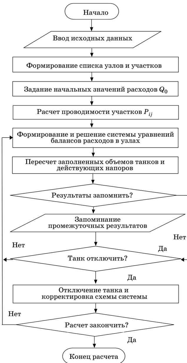
■ Рис. 5. Обобщенная блок-схема алгоритма расчета погрузки нефти
