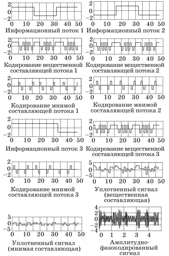
■ Рис. 3. Уплотнение трех канальных сигналов
