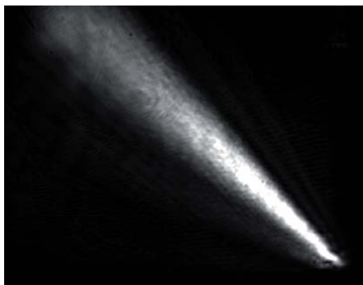
■ Рис. 2. Структура сдвиговой волны в плоскости (001) кристалла \text{TeO}_2
