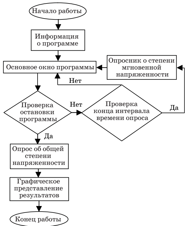
■ Рис. 2. Структура модуля автоматизации оценки напряженности
