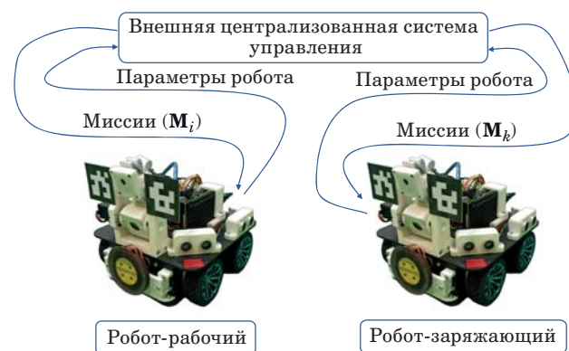
■ Рис. 2. Информационный обмен между роботами и системой управления группой
