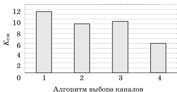
■ Рис. 4. Оценки коэффициента сжатия K_{сж} для алгоритмов выбора спектральных каналов: 1 — оптимальный алгоритм; 2 — алгоритм анализа приращений; 3 — алгоритм на основе вейвлет-анализа; 4 — алгоритм равномерного прореживания
