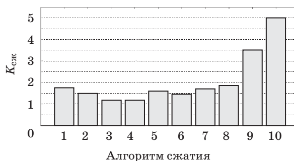
■ Рис. 3. Оценки коэффициента сжатия K_{сж} для различных алгоритмов сжатия видеоданных: 1 — WinRar; 2 — WinZip; 3 — TIFF; 4 — PNG; 5 — RLE; 6 — LZW; 7 — JPEG; 8 — JPEG2000 LS; 9 — JPEG2000 Low; 10 — JPEG2000 High
