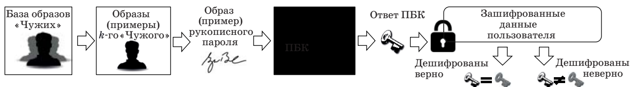
■ Рис. 1. Попытка подбора рукописного пароля для дешифрования контента ■ Fig. 1. Trying to matching handwriting password for decrypting the content
