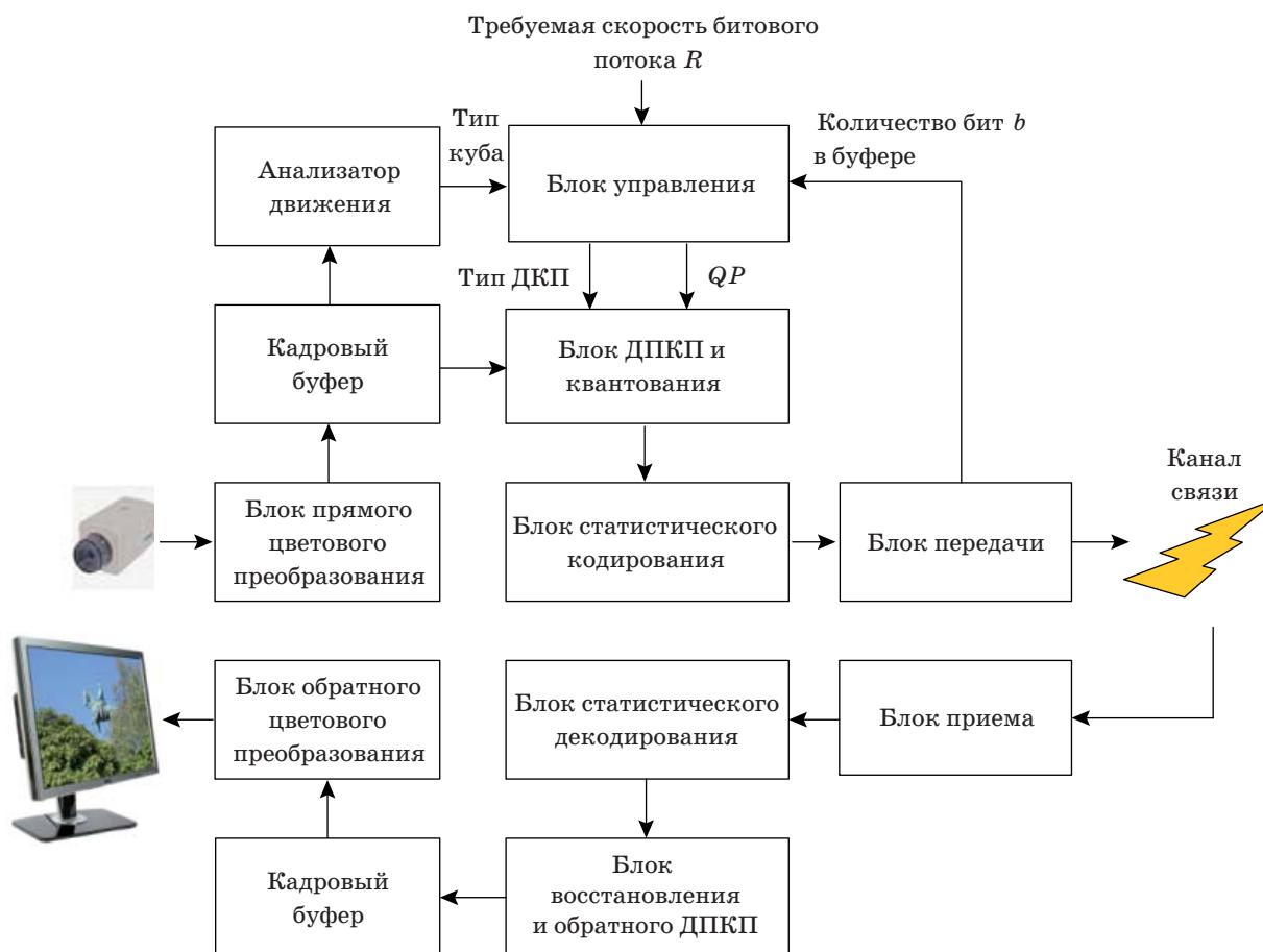
■ Рис. 1. Функциональная схема системы видеонаблюдения
