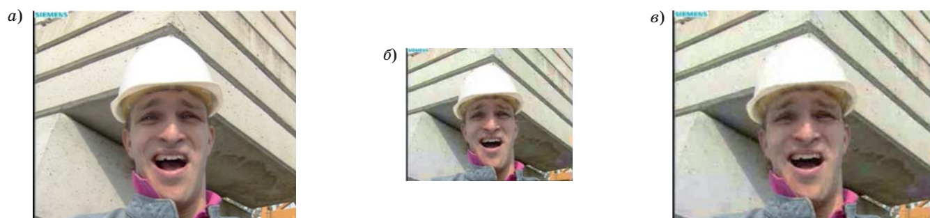
■ Рис. 5. Декодированные кадры иерархического кодирования по пространству: а — исходное изображение видеоряда («foreman») [10]; б — декодированный кадр базового слоя; в — декодированный кадр базового и расширяющего слоев
