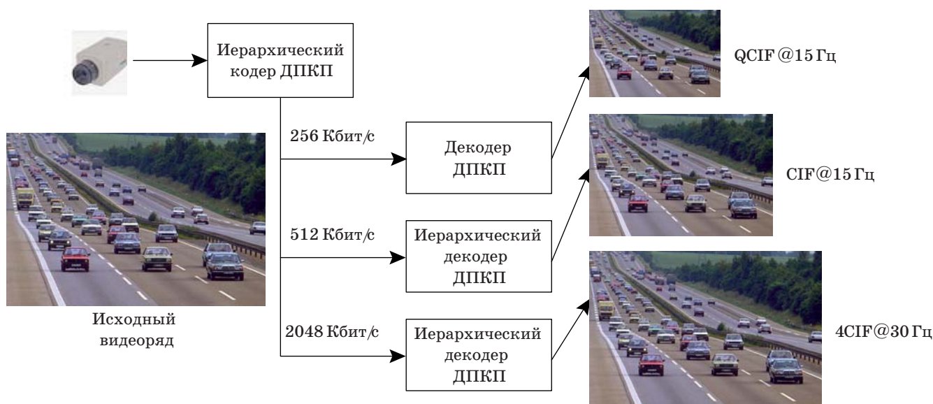
■ Рис. 3. Схема кодирования и декодирования иерархического кодера
