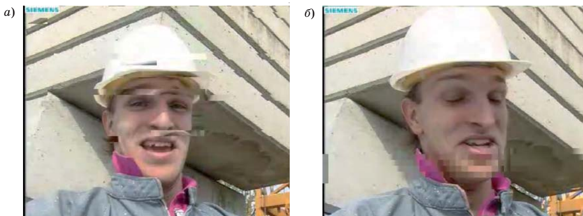
■ Рис. 14. Воздействие канальной ошибки с вероятностью потери пакета 0,1 на базовый (а) и иерархический (б) потоки
