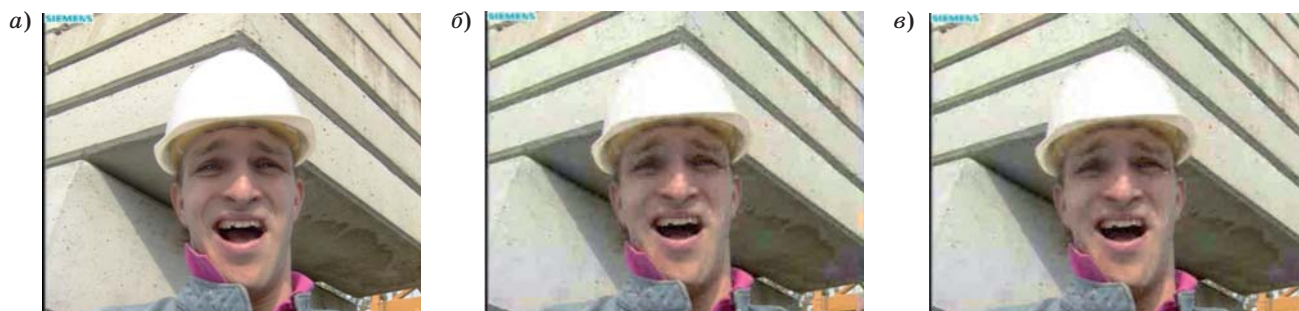
■ Рис. 7. Представление декодированных слоев иерархического кодирования по времени: a — исходная видео-последовательность; b — декодированный кадр базового слоя; c — декодированный кадр расширяющего слоя
