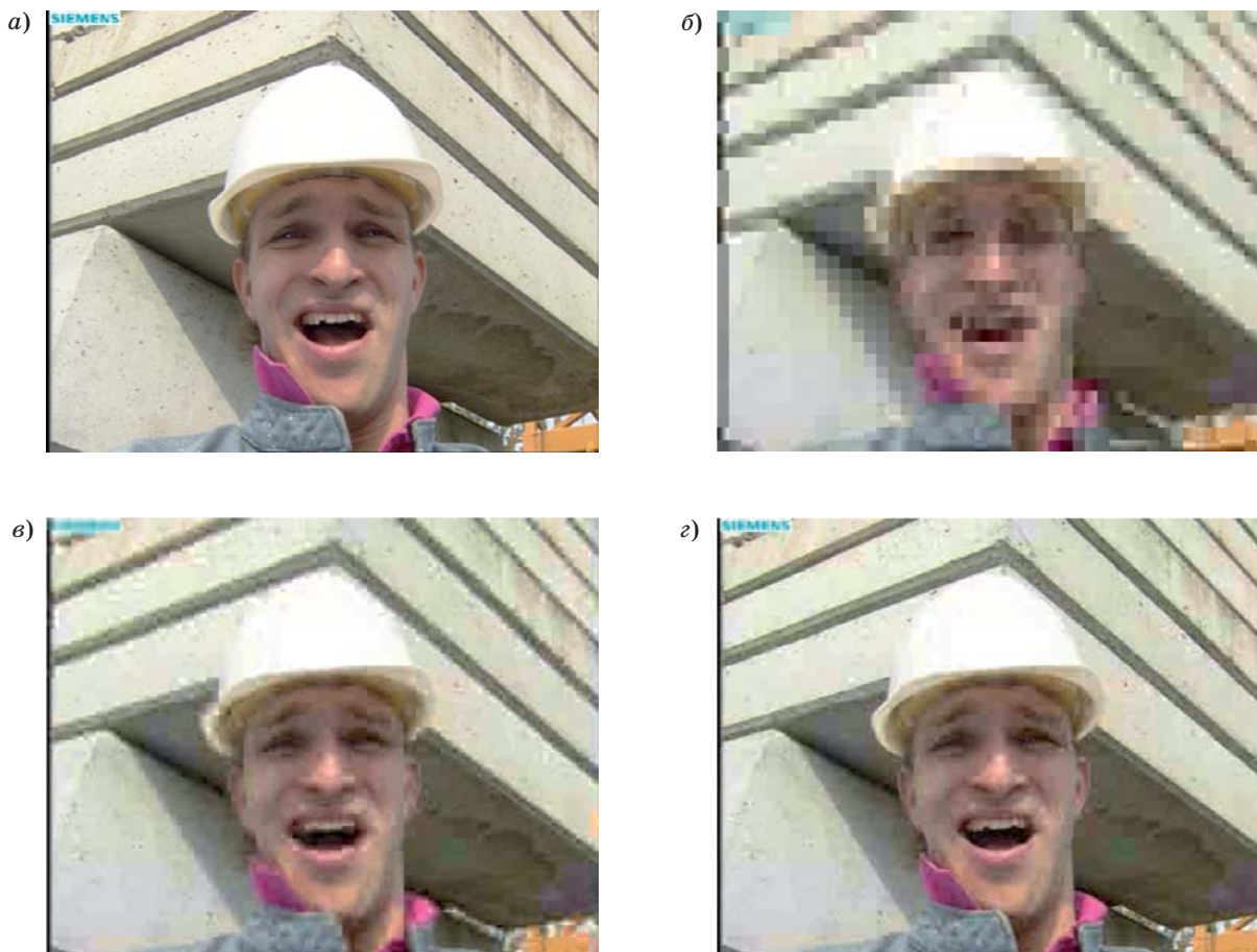
■ Рис. 10. Представление иерархического кодирования с масштабированием по качеству: a — исходное видео-изображение; б — базовый слой; в — базовый поток и расширяющий поток 1; г — базовый поток и расширяющие потоки 1 и 2
