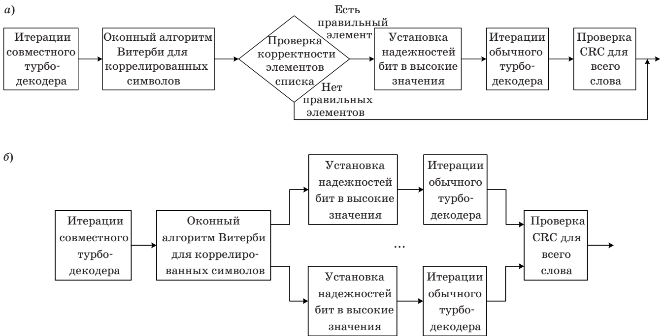
■ Рис. 4. Схема совместного списочного турбодекодера с возможностью (а) и без возможности (б) проверки корректности символов источника
