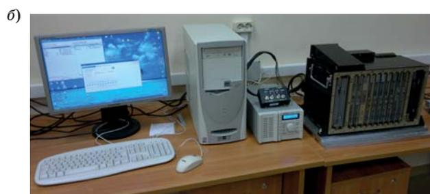
■ Рис. 6. Схема (а) и пример (б) АРМ для проверки БЦВС класса ИМА (БЦВС справа)
