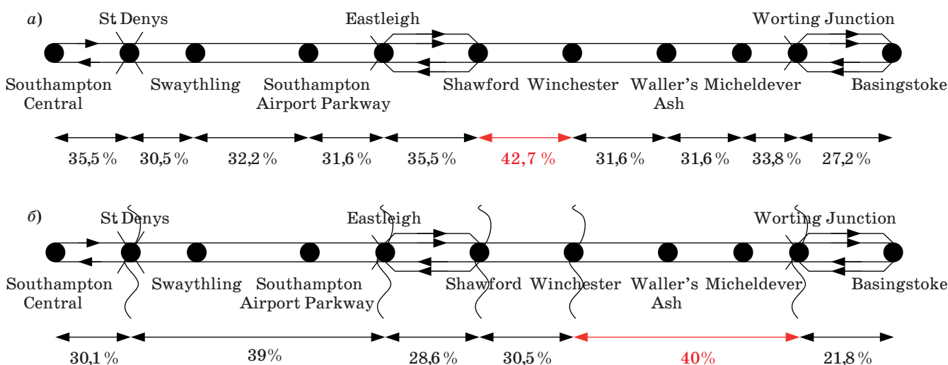
■ Рис. 4. Сжатие расписания методом CUI (а) и UIC 406 (б)
