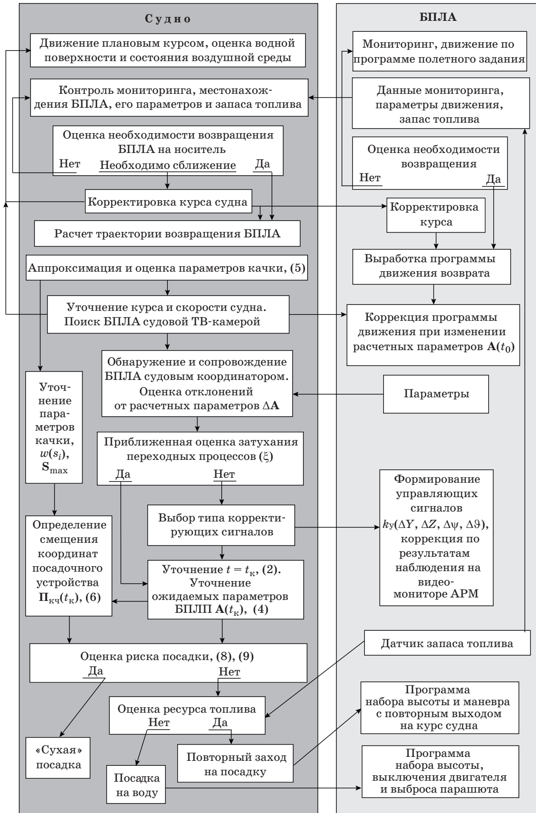
■ Рис. 2. Схема информационного взаимодействия судна и БПЛА при посадке
