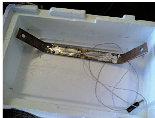
■ Рис. 6. Моделирование электрических соединений ВТСП-лент
