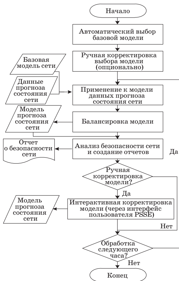
■ Рис. 5. Модульное построение процесса на примере создания модели предсказания состояния сети. © Swissgrid, 2005–2012
