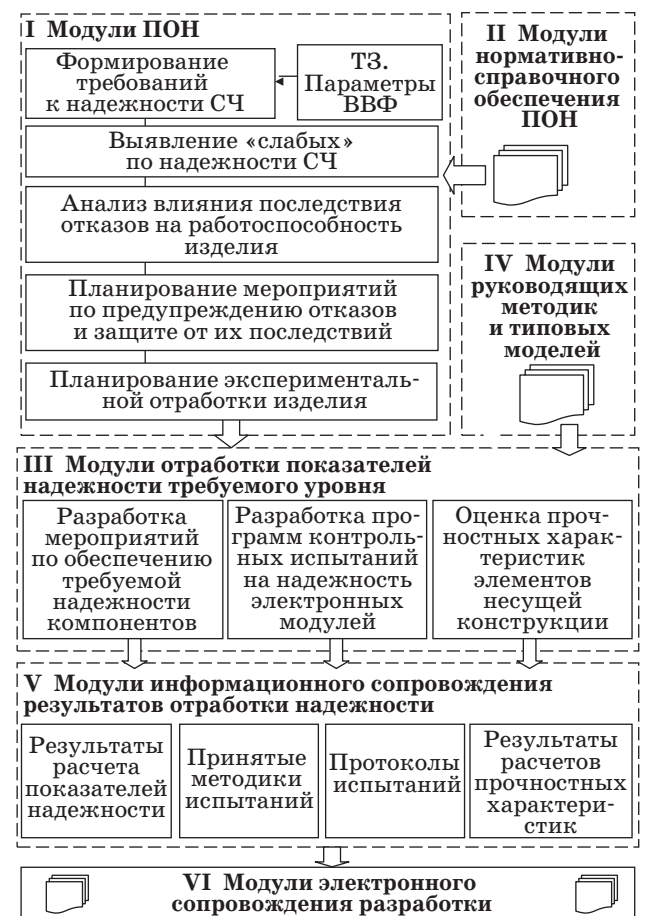
■ Рис. 2. Функциональная модель информационно-сопровождения отработки на надежность сложных ответственных изделий: ПОН — программа обеспечения надежности; СЧ — составная часть; ВВФ — внешние воздействующие факторы
