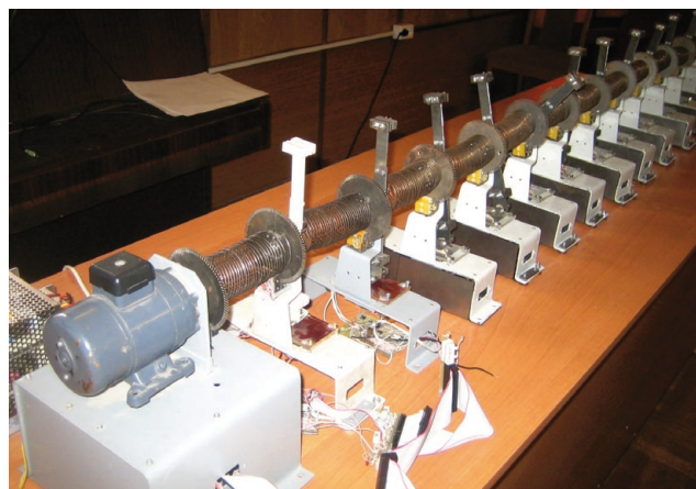
■ Рис. 1. Многомаятниковый мехатронный комплекс ИПМаш РАН
