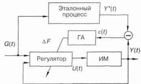
Рис. 5. Настройка регулятора с помощью ГА
