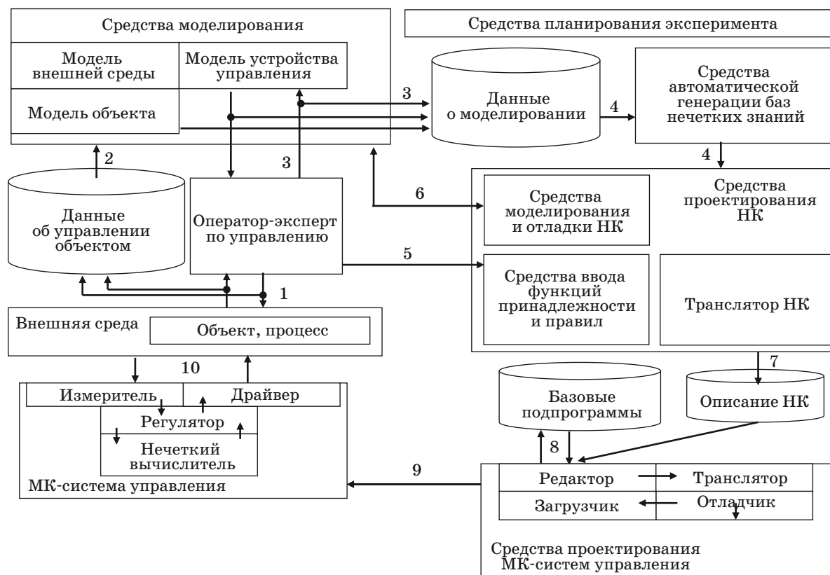
■ Рис. 9. Методика проектирования ВИСУ с нечеткой обработкой данных
