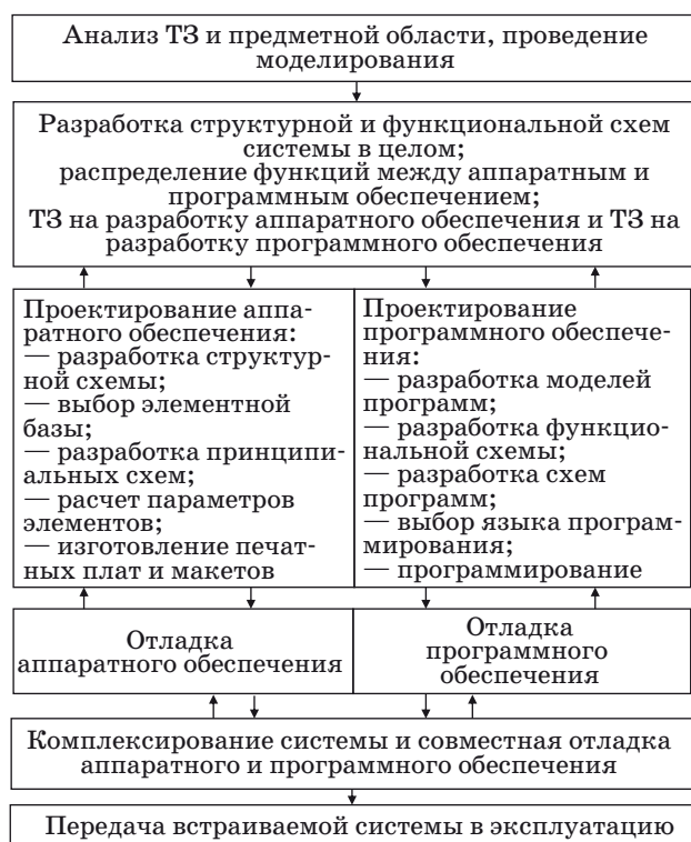
■ Рис. 1. Стадии проектирования встраиваемой системы на базе МК
