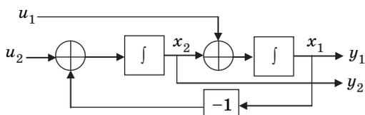
■ Рис. 3. Структурная схема ОД второго порядка
