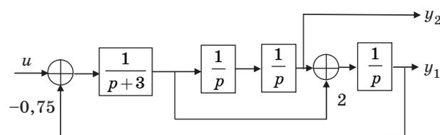
Рис. 5. Структурная схема ОД четвертого порядка
