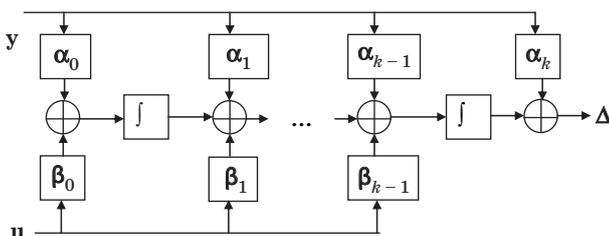
■ Рис. 2. Схема устройства функционального диагностирования
