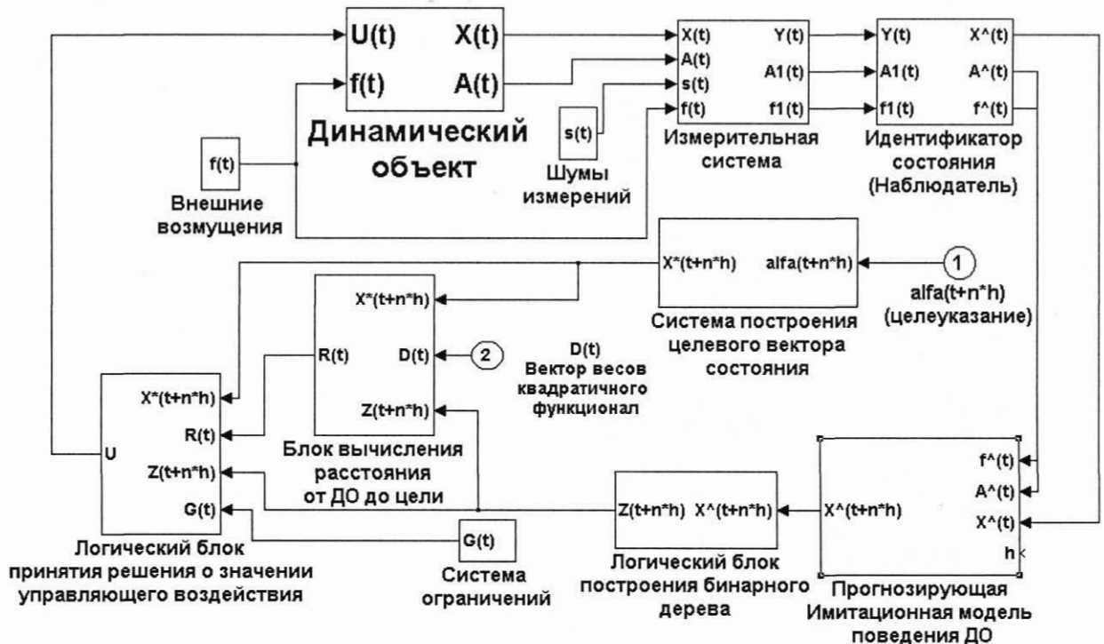
Рис. 4. Структурная схема системы логического управления
