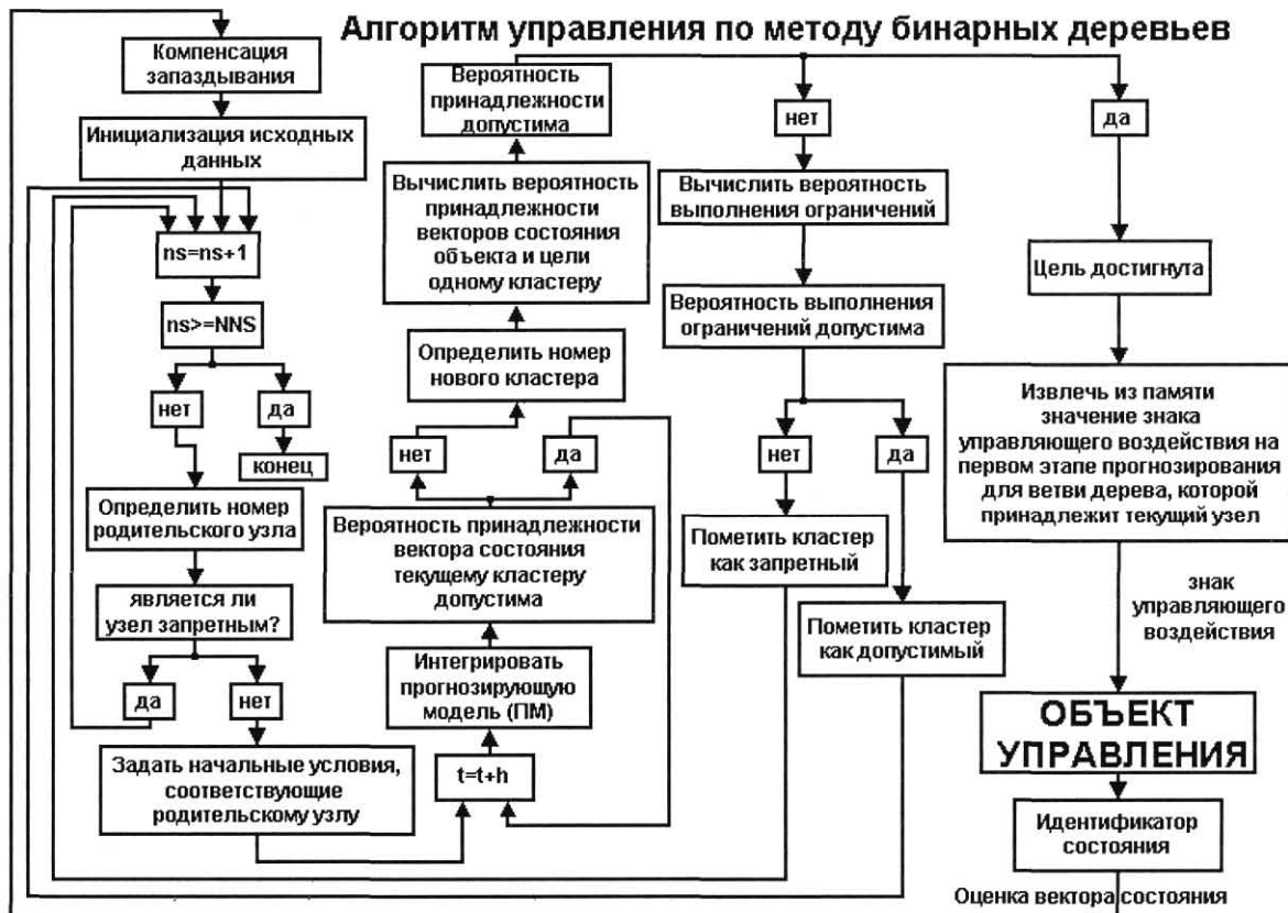
■ Рис. 3. Блок-схема алгоритма управления по методу БД
