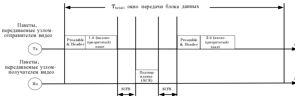
■ Рис. 4. Схема передачи видео, успешная передача
