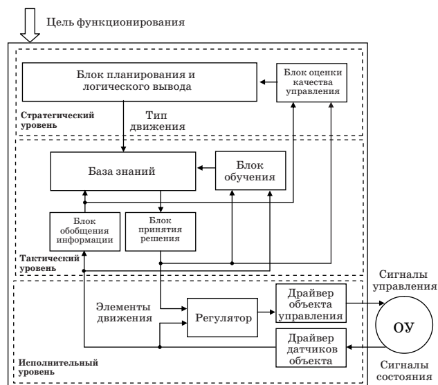
■ Рис. 1. Обобщенная структура трехуровневой модели ВИСУ
