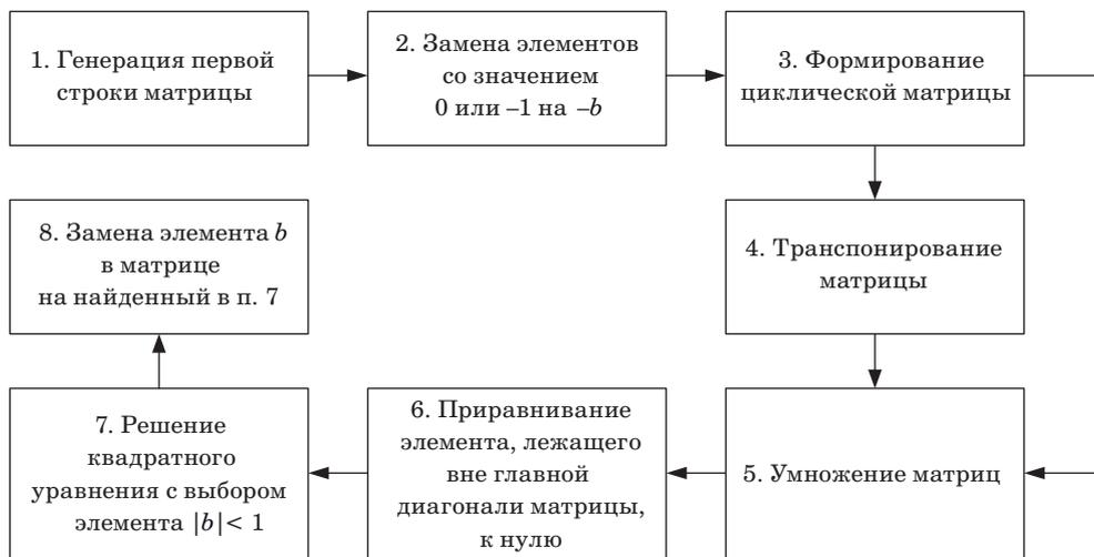
■ **Рис. 2.** Структурная схема метода вычисления элемента  $b$
