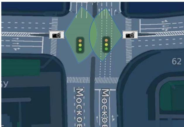
■ **Рис. 7.** Предлагаемые места установки камер фото- и видеofиксации на рассматриваемом месте концентрации ДТП
