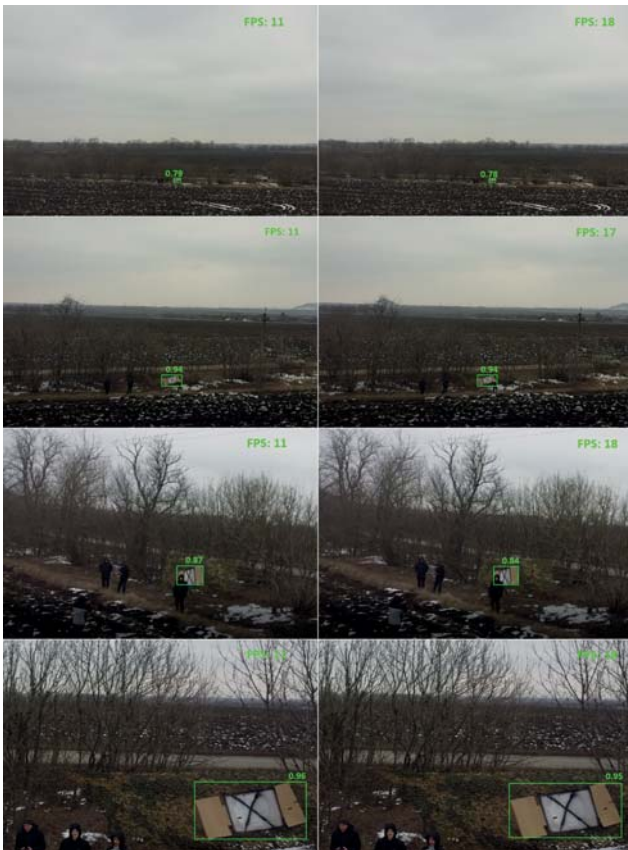
■ Рис. 3. Результат сравнительного эксперимента стандартной (слева) и модифицированной (справа) YOLOv8m
