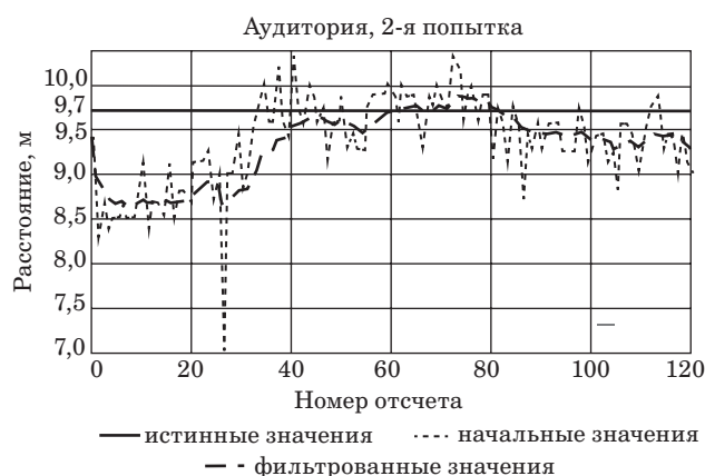
■ Рис. 13. Оценка дальности после обработки отсчетов фильтром Калмана, полученных в помещении
