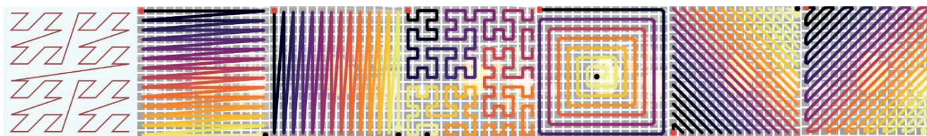
■ Рис. 4. Кривые Пеано. Слева направо: кривая Мортон (z-order), разбиение по строкам, разбиение по столбцам, кривая Гильберта, спираль, диагональ, змеевидная кривая
