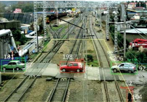
■ Рис. 1. Размер объектов наблюдения на кадре с разрешением 1280 \times 720 пикселей ■ Fig. 1. Observed object dimensions within the 1280 \times 720 frame
