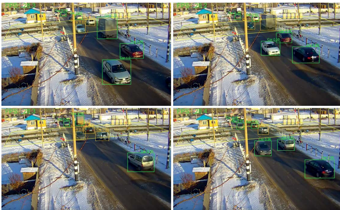
■ Рис. 6. Примеры детекции OptiYOLO на реальных кадрах ■ Fig. 6. OptiYOLO detection examples on real-world frames
