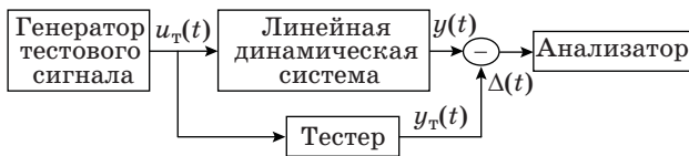
■ Рис. 2. Схема системы тестового диагностирования
