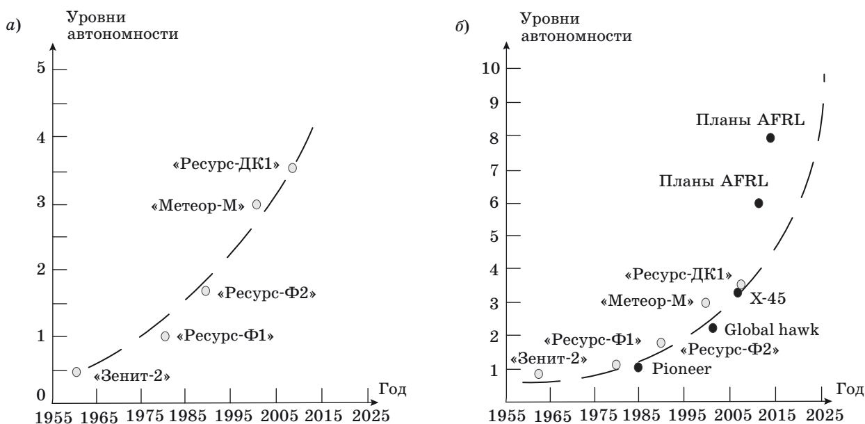
■ Рис. 1. Уровни автономности некоторых зарубежных и отечественных аэрокосмических средств: а — по классификации NASA; б — по классификации МО США
