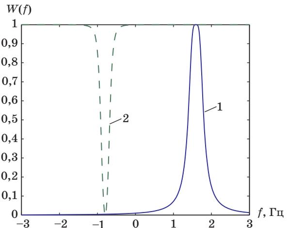
■ Рис. 1. Амплитудно-частотные характеристики полосового 1 и режекторного 2 комплексных фильтров
