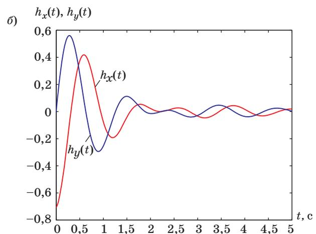
■ Рис. 2. Импульсные характеристики полосового (а) и режекторного (б) фильтра
