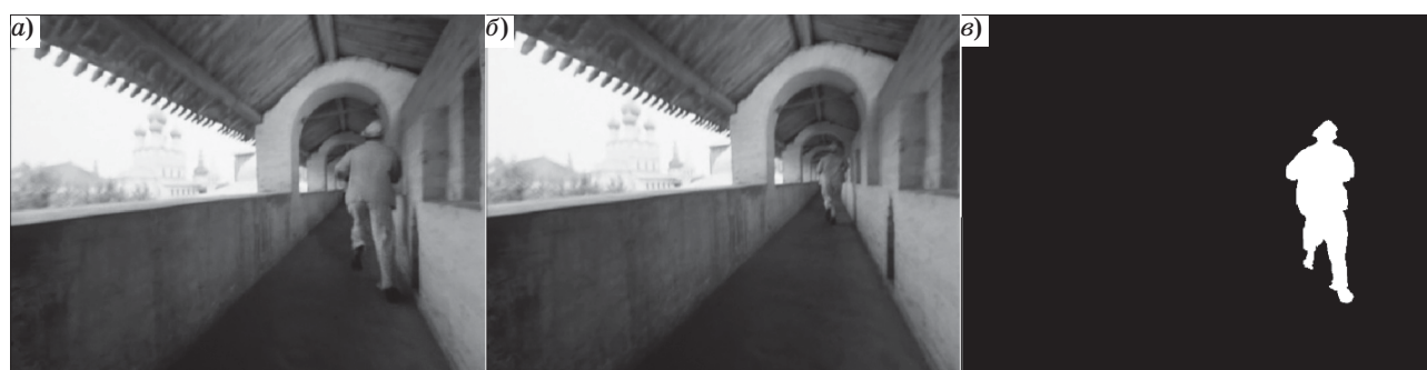
■ Рис. 5. Создание фонового изображения из двух кадров: а, б — исходное изображение, на котором движущийся объект (человек) находится соответственно относительно близко к камере и далеко от камеры; в — силуэт этого движущегося объекта
