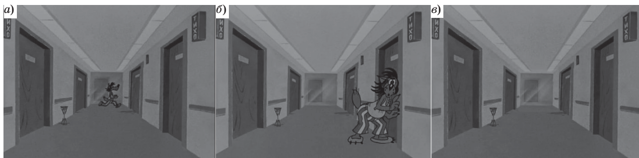
■ Рис. 4. Создание фонового изображения из двух кадров: а, б — исходные изображения, включающие в себя объект (волка в разных местах коридора и фоновую часть); в — фоновое изображение, полученное из первых двух путем монтажа
