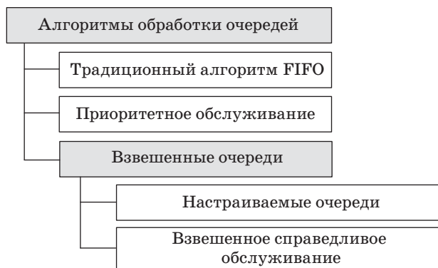
■ Рис. 3. Классификация алгоритмов обработки очередей маршрутизатора ■ Fig. 3. Classification of router queue processing algorithms
