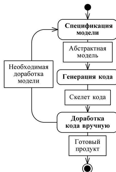
■ Рис. 1. Цикл разработки с использованием порождающего программирования
