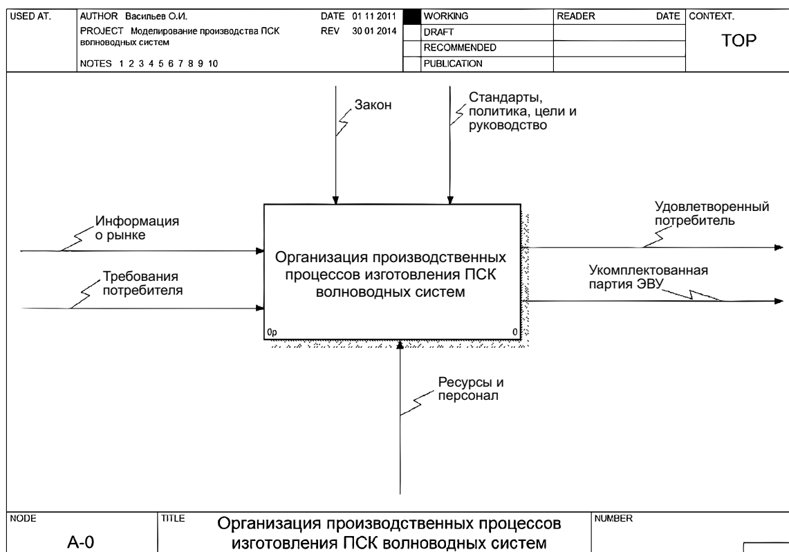
■ Рис. 1. Пример контекстной диаграммы «Организация производственных процессов изготовления ПСК волноводных систем»: ЭВУ — элемент волноводного узла
