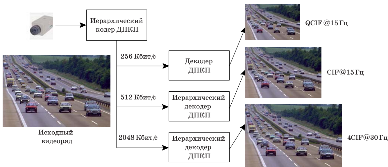
■ Рис. 3. Схема кодирования и декодирования иерархического кодера
