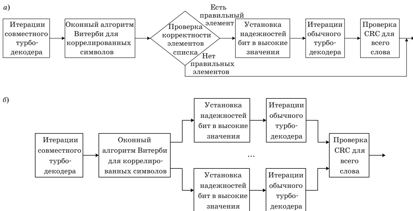
■ Рис. 4. Схема совместного списочного турбодекодера с возможностью (а) и без возможности (б) проверки корректности символов источника
