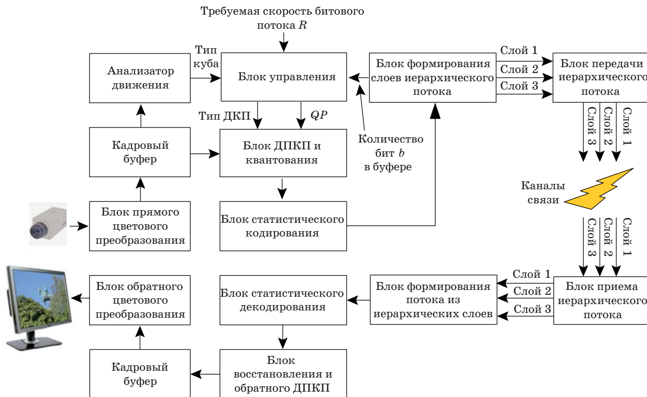
■ Рис. 11. Схема иерархического кодирования для системы видеонаблюдения с использованием ДПКП и принципа ПЦЯ
