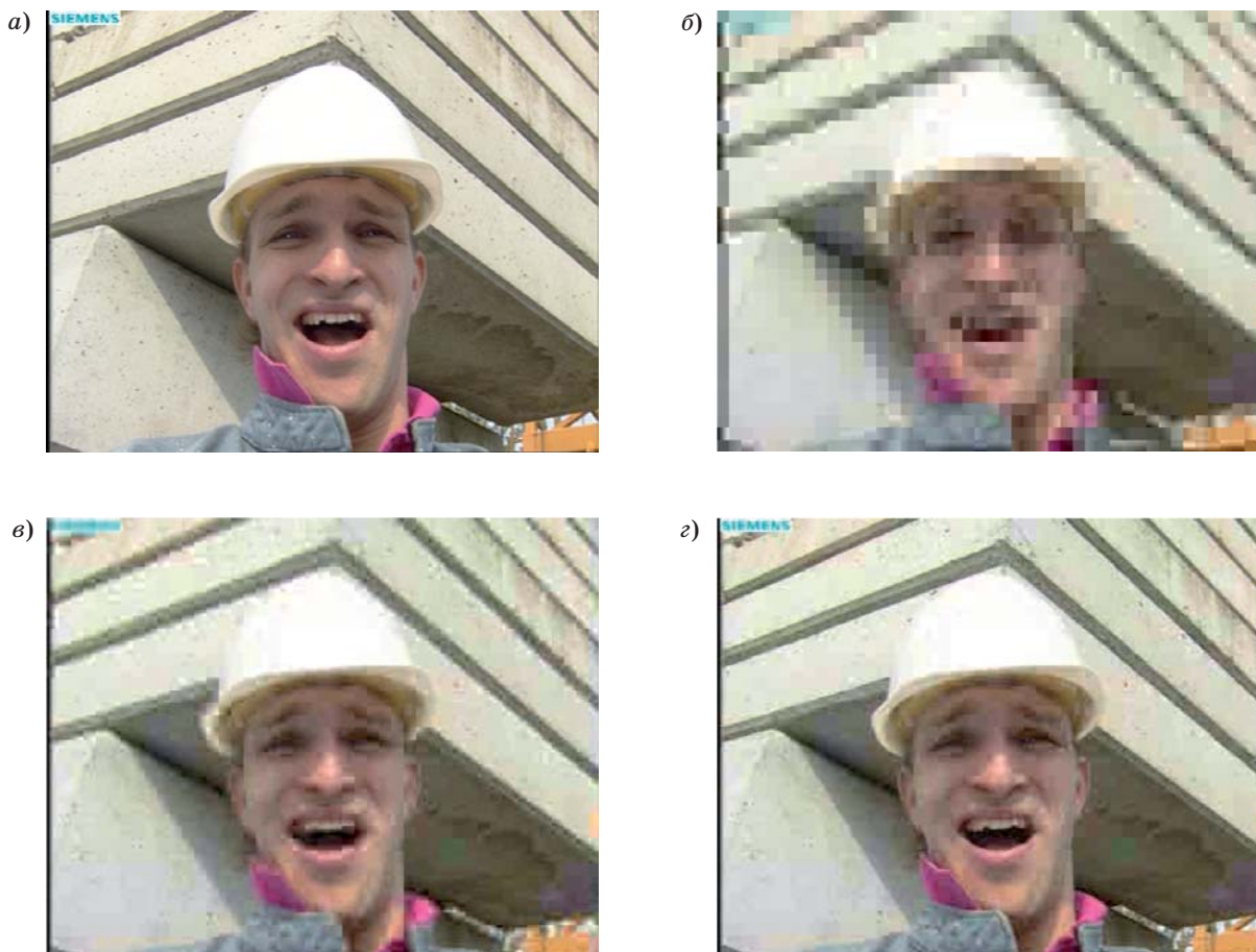
■ Рис. 10. Представление иерархического кодирования с масштабированием по качеству: a — исходное видеозображение; б — базовый слой; в — базовый поток и расширяющий поток 1; г — базовый поток и расширяющие потоки 1 и 2
