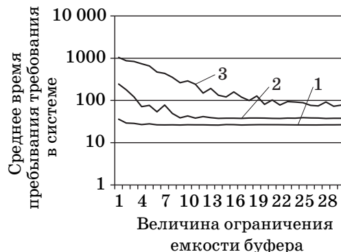
■ Рис. 2. Зависимость среднего времени пребывания требования в системе от разрешенной величины буфера для значений интенсивности входящего потока: 1 — \lambda = 0,04 ; 2 — \lambda = 0,05 ; 3 — \lambda = 0,06 ; \mu_0 = 0,066
