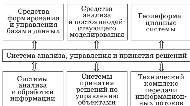
■ Рис. 1. Блок-схема системы анализа, управления и принятия решений
