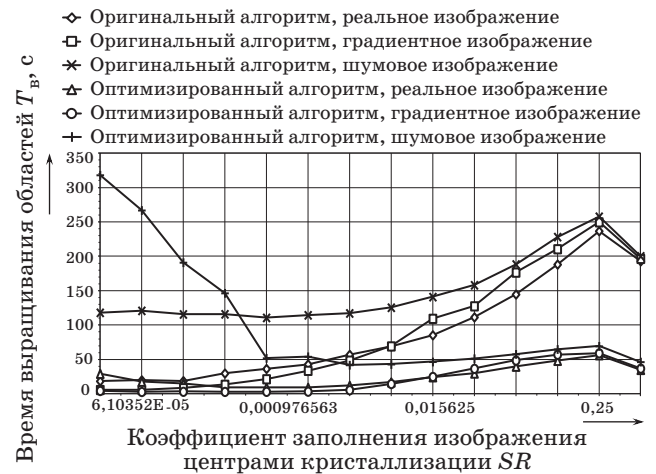
■ Рис. 12. Графики зависимости времени выращивания областей T_B от коэффициента заполнения изображения центрами кристаллизации SR ( n = 30 тыс. пикселей)
