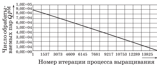
■ Рис. 6. Зависимость количества обрабатываемых пар «сегмент — граничный пиксель» QP^M в процессе выращивания областей при максимально плотной расстановке центров кристаллизации
