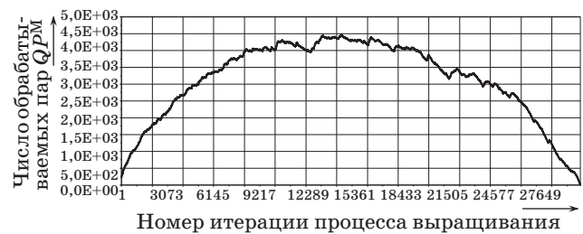
■ Рис. 4. Типичная зависимость количества обрабатываемых пар «сегмент — граничный пиксель» QP^M в процессе выращивания областей
