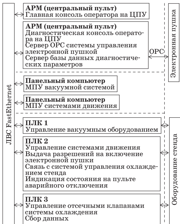
■ Рис. 1. Структурная схема КСУ
