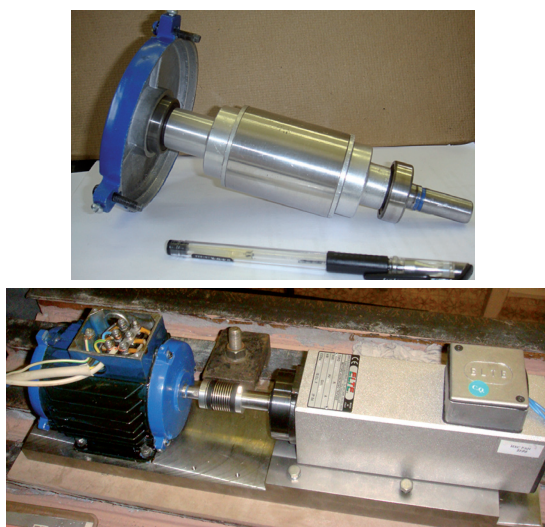
■ Рис. 8. Ротор модельного мини-турбогенератора с органосиликатным покрытием и мини-турбогенератор на испытательном стенде
