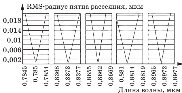
■ Рис. 9. Спектральная зависимость RMS-радиуса пятна рассеяния для объектива, представленного на рис. 8
