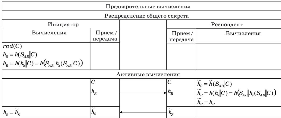
■ Рис. 4. Схема выполнения корреспондентами протокола двусторонней аутентификации
