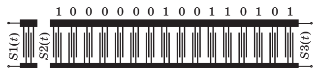
■ Рис. 3. Согласованный фильтр ФКМ-сигнала
