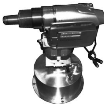
■ Рис. 1. Специальный испытательный стенд с видеокамерой
