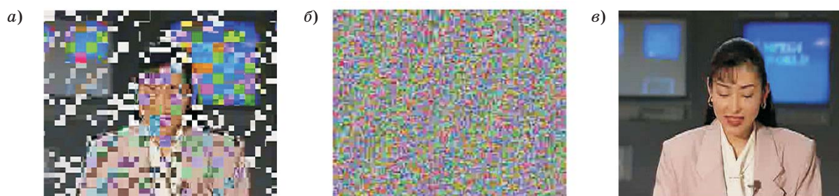
■ Рис. 1. Пример использования алгоритма RVEA (а), алгоритма Video Encryption Algorithm (б) к исходному изображению (в)
