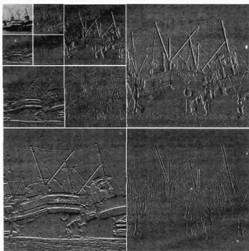
■ Рис. 6. Компоненты, полученные в результате трехкратного вейвлет-преобразования тестового изображения «Яхта»
