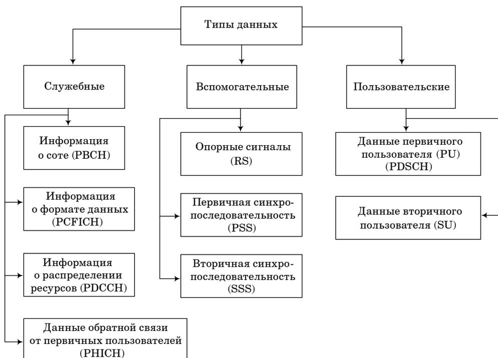
■ **Рис. 1.** Классификация типов данных в когнитивной системе связи на базе LTE
