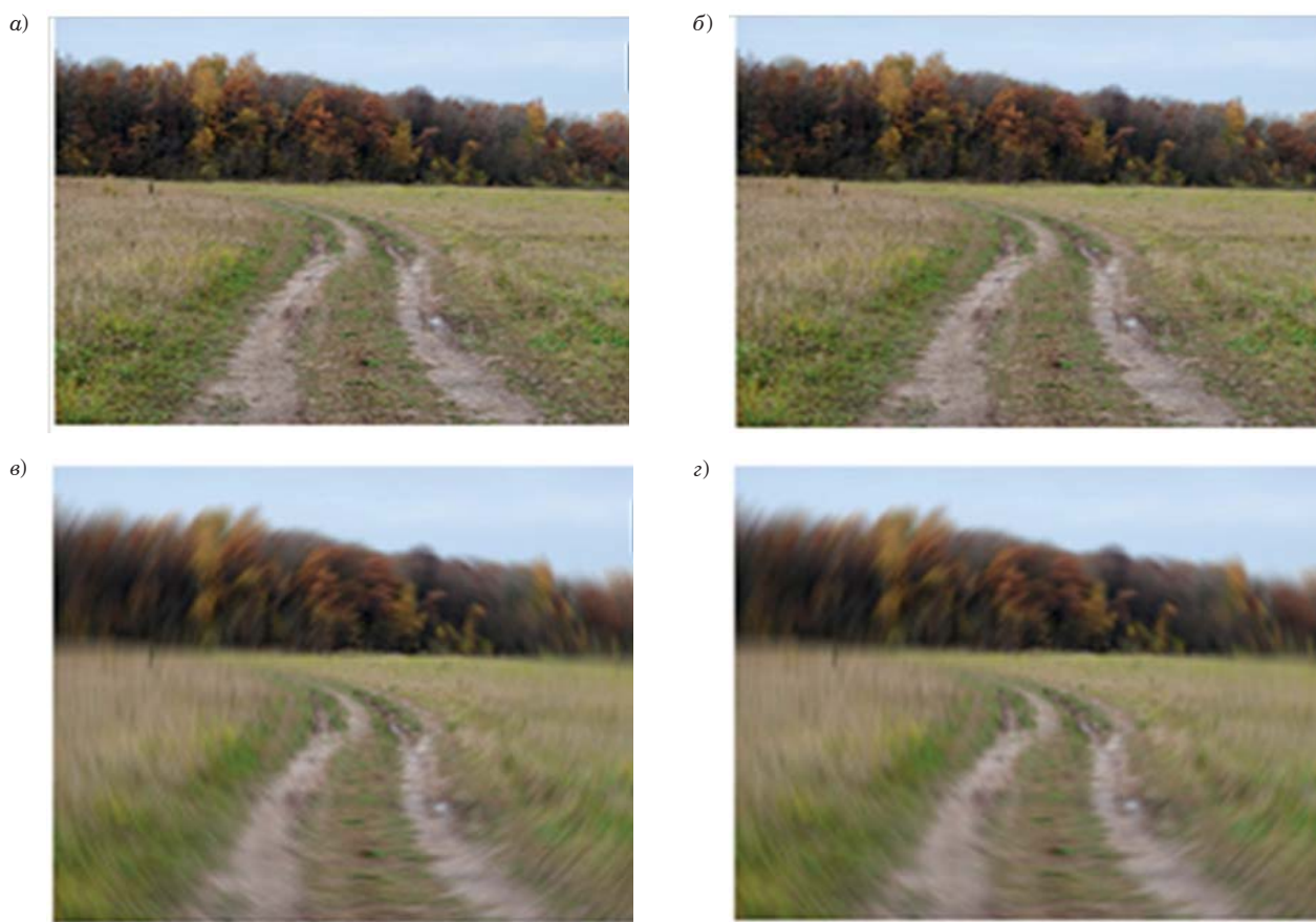
■ Рис. 4. Изображения сцены, полученные для разных условий наблюдения: a – исходное изображение, полученное с неподвижного МР; б – изображение при продольных вертикальных колебаниях платформы МР; в – поперечные горизонтальные колебания платформы; г – совмещение продольных и поперечных колебаний платформы
