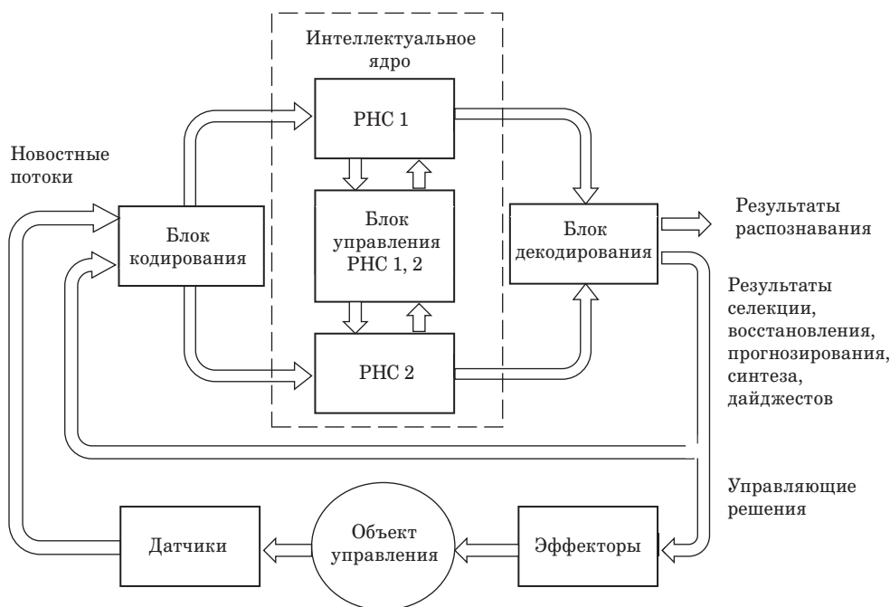
■ Рис. 1. Структура системы нейроуправления новостными потоками ■ Fig. 1. Structure of the news flow neural control system
