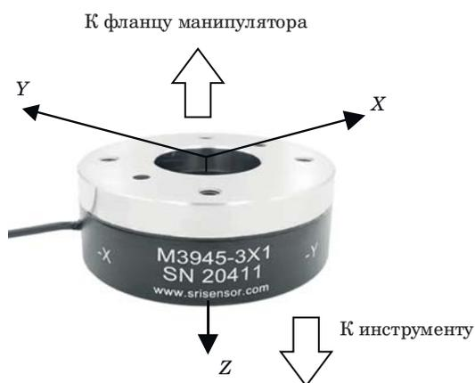
■ **Рис. 6.** Система координат датчика силы
